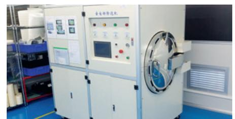
Autoklav für Optical Bonding
