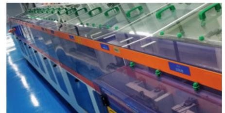
Reinigen und Ätzen der ITO-Schicht
